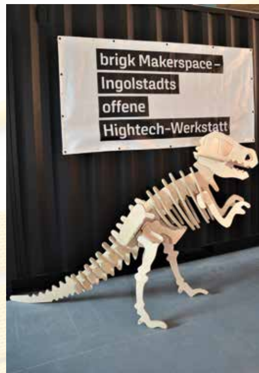
Der T-Rex besteht aus Einzelteilen, die mit der CNC-Fräse aus Holzplatten geschnitten wurden (Fotos: Arzenheimer)
